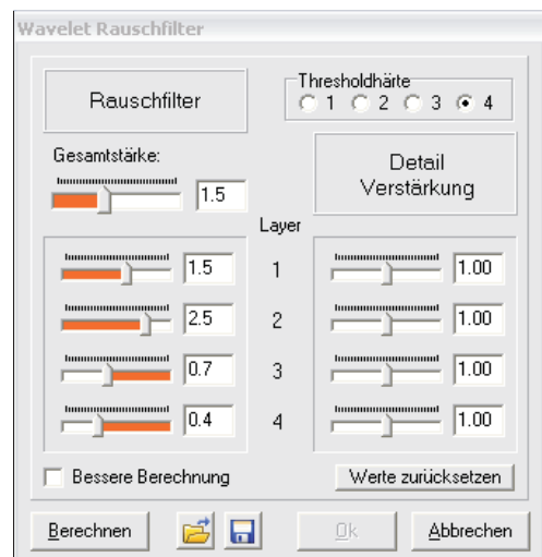
Abb. 4-49: Wavelet Rauschfilter in FITSWORK mit Einstellungen, die für ver-rauschte Nebelaufnahmen geeignet sind
