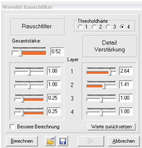
Abb. 4-48: Wavelet Rauschfilter in FITSWORK mit Einstellungen, die für Mond und Planeten geeignet wären
